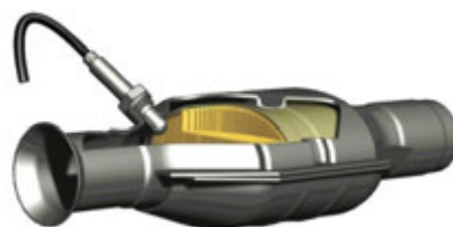
Obr. 2.3 Katalyzátor výfukových plynov
