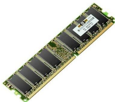
Obrázok 7: Pamäťový modul počítača
