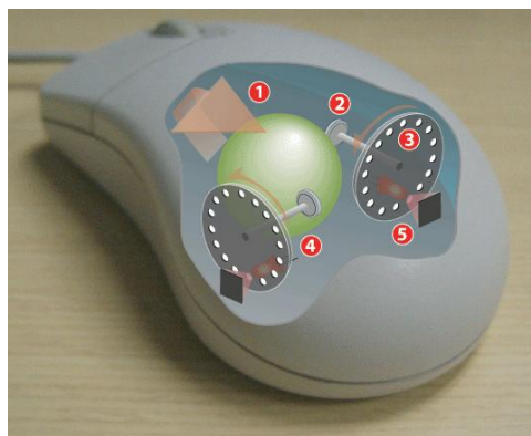
Obr. 32: Mechanická myš a jej princíp činnosti
