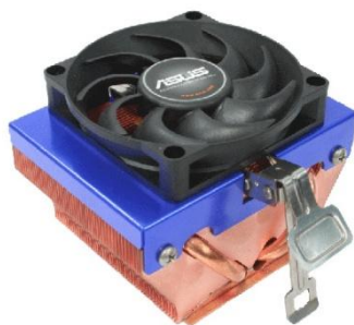
Obrázok 9: Aktívny chladič procesora
