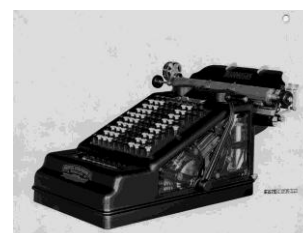
Príprava diernych štitkov zo sčítacích hárkov
