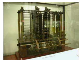
Model časti Babbageovho analytického stroja
