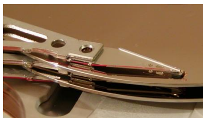
Obrázok 16: Detailný pohľad na ramená disku s čítacími a zapisovacími hlavami.
